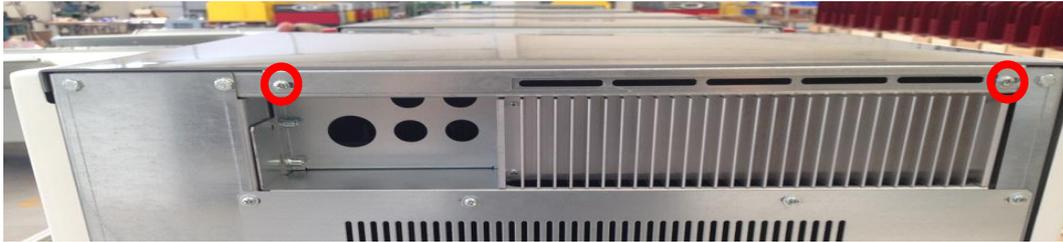
Figura 72 - Rimontaggio pannello superiore
