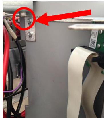
Figura 9 – Rimozione angolo led
