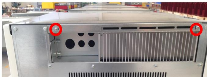
Figura 3 – Rimozione pannello superiore
