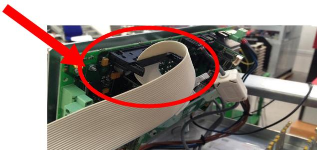
Figura 7 – Rimozione connettore "flat ribbon" dal suo connettore
