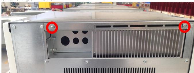
I 3 pannelli laterali colorati sono fissati al resto della struttura nella parte superiore da pioli orizzontali inseriti a pressione in delle guide, mentre nella parte inferiore hanno dei ganci che vanno infilati in appositi buchi nel telaio.
