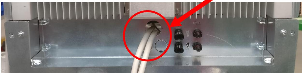
Figura 29 - Installazione pressacavo per cavo GRID ed EPS
