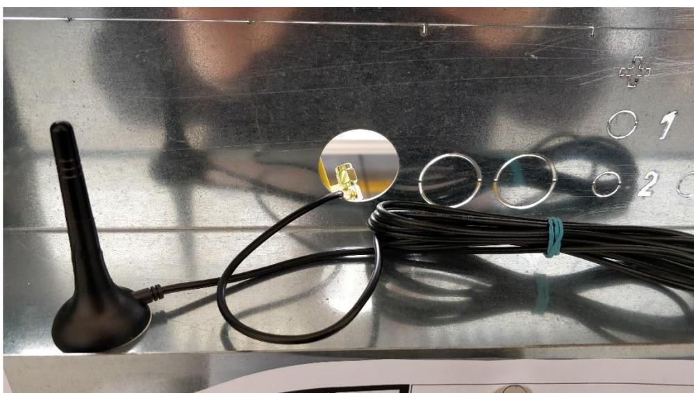
Figura 19 – Passaggio cavo antenna in foro di passaggio su pannello posteriore; completare con idoneo pressacavo
