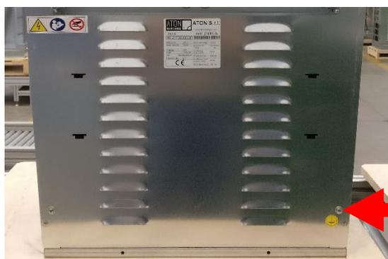
**VITE DA UTILIZZARE PER COLLEGARE LA MASSA DELLA MACCHINA ALL'IMPIANTO DI TERRA DELL'UTENZA**
