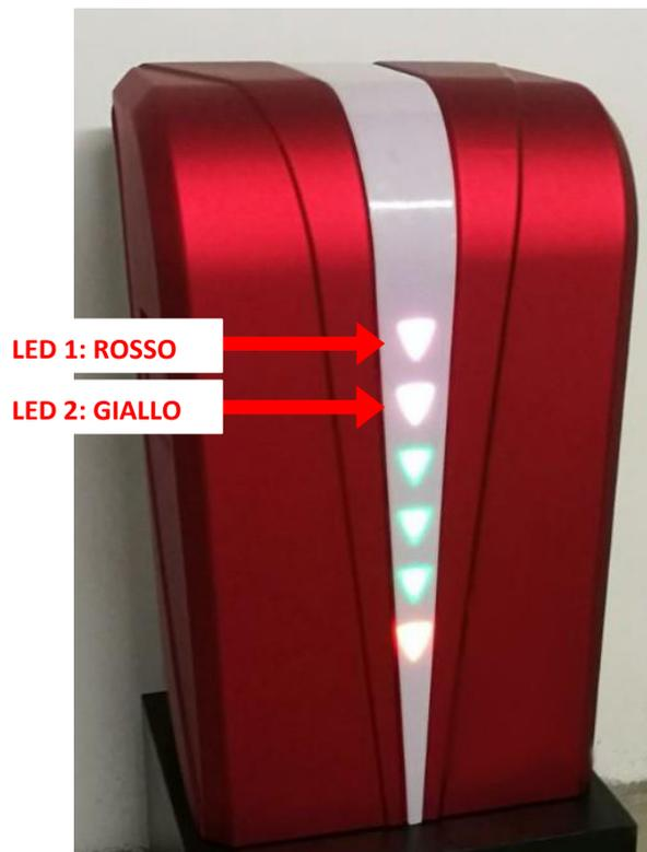
Figura 61 - Verifica Led in funzione EPS
