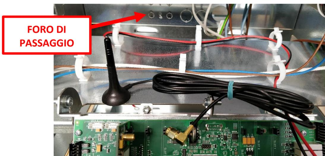
Figura 18 – Identificazione foro di passaggio cavo antenna su pannello posteriore
