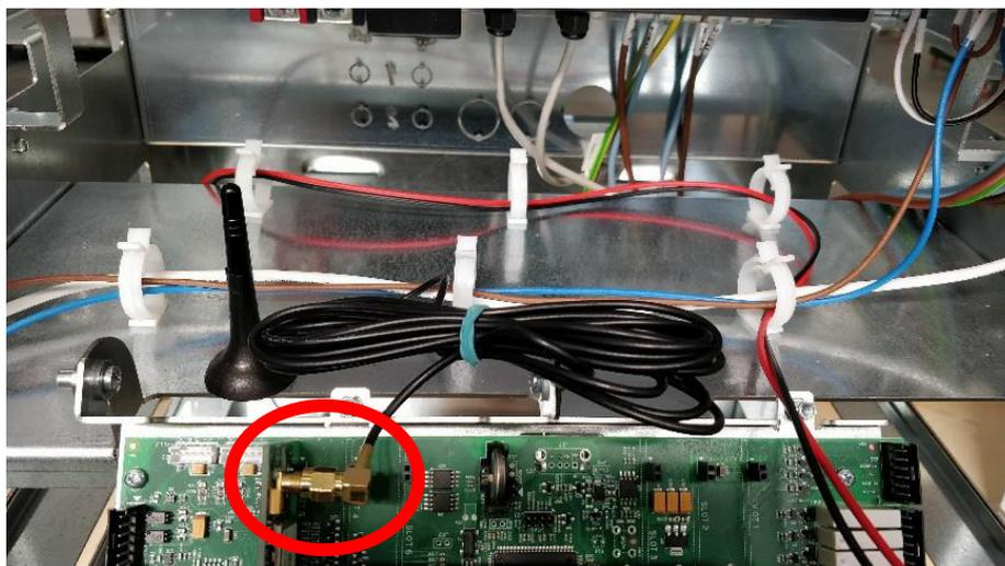
Figura 17 – Connettore dorato antenna
