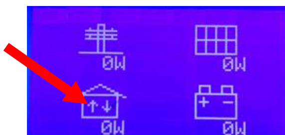
Figura 63 - Verifica della comunicazione attiva con il portale Aton
