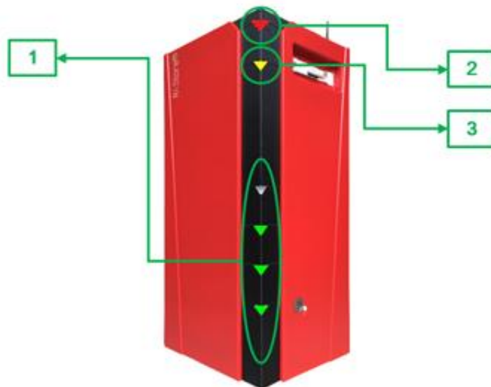
Figura 48 - Verifica Led in funzione EPS
