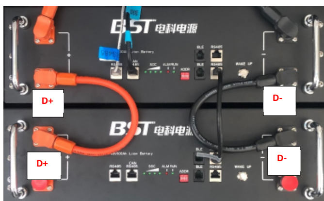
Figura 32 – Collegamento cavi alimentazione batterie BST MD48-100-3U
