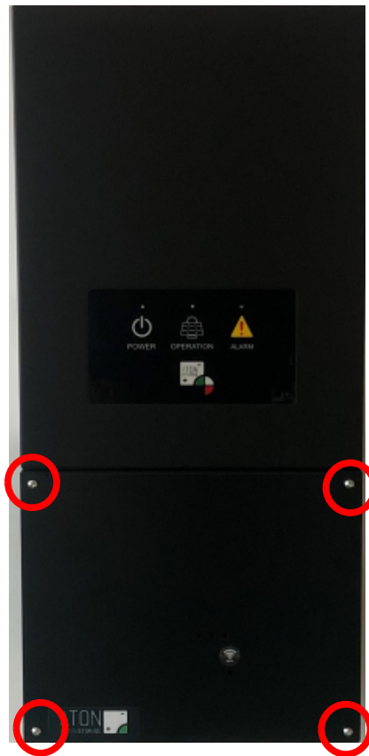
Figura 60 - Rimozione coperchio morsettiera ATH-BOX
