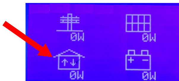
Figura 111 - Verifica della comunicazione attiva con il portale Aton
