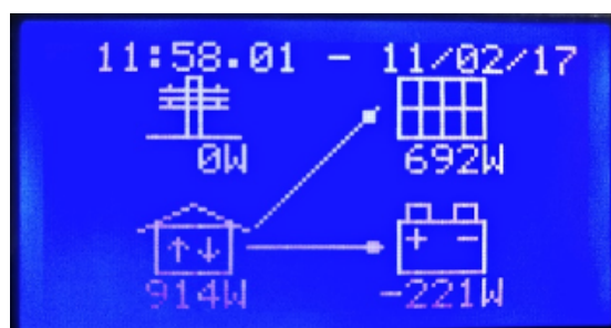
Figura 90 - Visualizzazione dopo che è stata azzerata la potenza visualizzata sotto l'icona TRALICCIO da parte dell'accumulo
