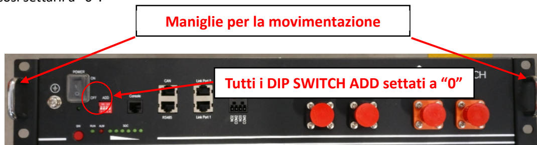
Figura 6 - Modulo batteria Pylontech: maniglie per la movimentazione
